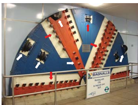
盾构机易磨损部位
